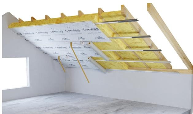
4. An den Stellen, an denen die Dampfsperre mit Wänden, Schornsteinen und anderen vertikalen Elementen verbunden ist, sollte besonders auf eine dichte Installation geachtet werden. Wir kleben die Dampfsperre mit speziellen Klebstoffen oder Klebebändern (z.B. Corotop BUTYL), um Luftzüge zu vermeiden.
